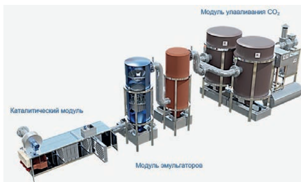
Рисунок 1 – Комплексная система очистки
