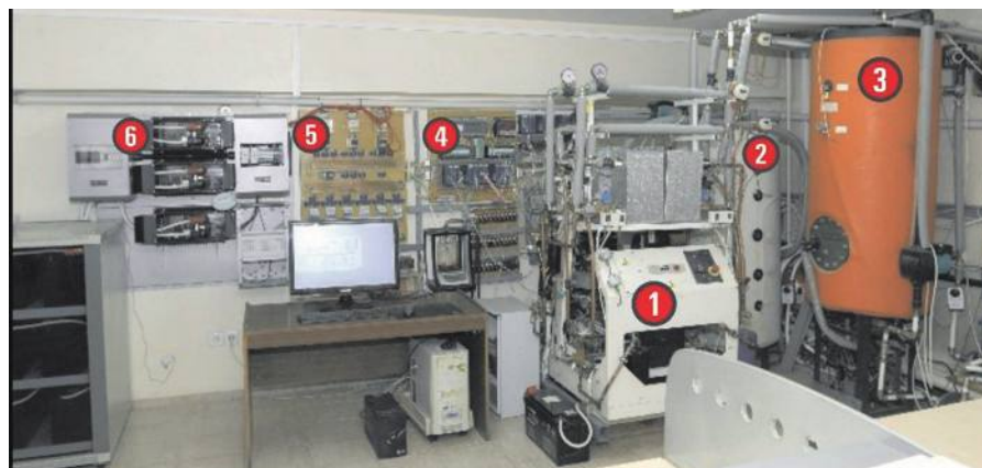
4-сурет. ЖЭК негізіндегі қосымша энергия көздерін интеграциялау жүйесі бар тәжірибелік үшгенерациялық қондырғы
